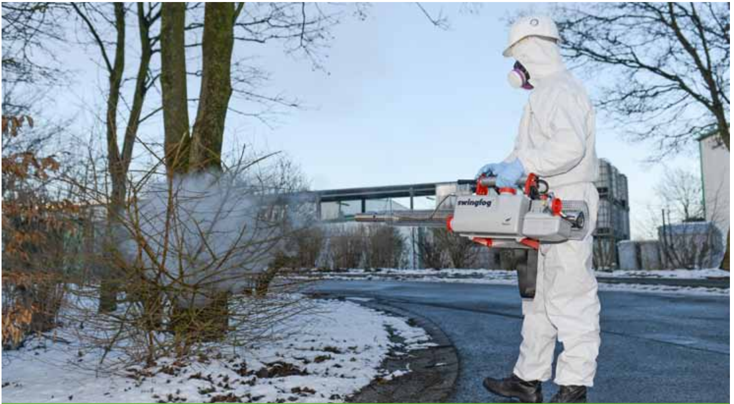
Nico Finke, IHK-gepr. Schädlingsbekämpfer und Sachverständiger für Schädlingsbekämpfung und Lebensmittelhygiene bedient ein Heißvernebelungsgerät, das vorzugsweise im Pflanzenschutz und für die Insektenbekämpfung in großen Hallen und Räumen eingesetzt wird.
