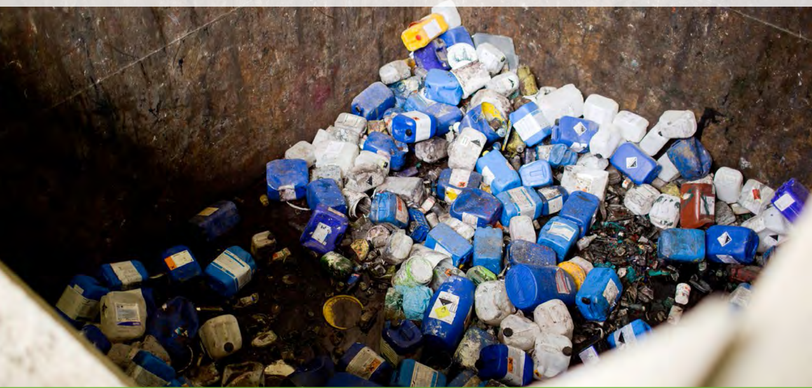
HDPE-Fässer und -Kanister als Inputmaterial für die Cryogenanlage. / HDPE drums and canister used as input material for the cryogenic treatment plant.
