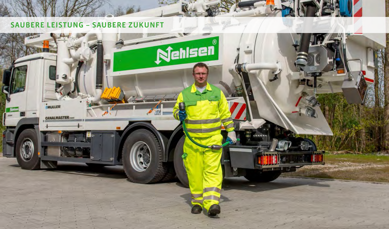
Das Saug-Spül-Fahrzeug ist mit einer „sehenden Düse“ ausgestattet. / Multi-functional vehicle (JetVac), equipped with a camera-mounted nozzle.
